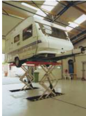
Plaatsbesparend in de werkplaats, dus efficiënt! (tafelbreedte 500 mm)
